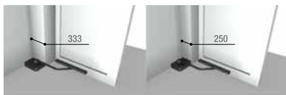
Application hors-sol côté long adjacent au pilier.
