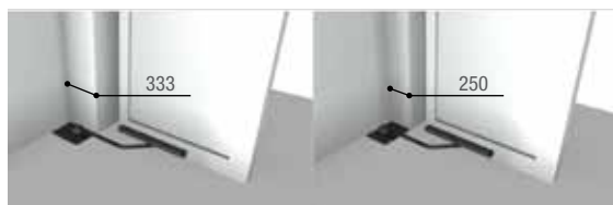
Application enterrée côté long adjacent au pilier.
